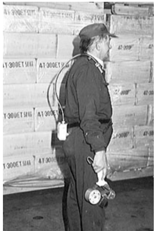
Figura 1- Muestreador personal y ropa de trabajo. No se consideran EPI.
